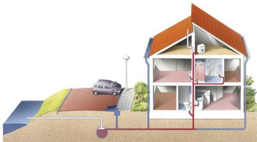
Figuur 1: Een gemengd stelsel: hemelwater en afvalwater worden via eenzelfde rioel afgevoerd naar de waterzuivering.
