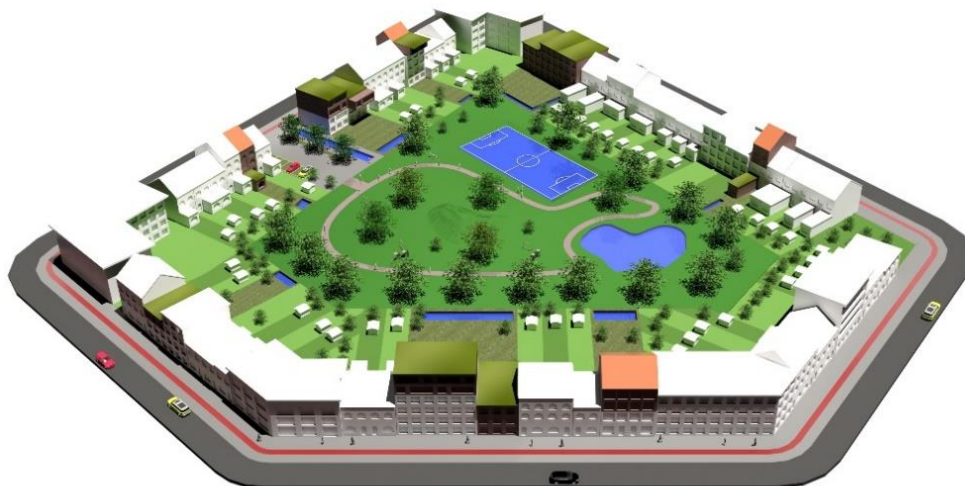
Figuur 5: Bij een nieuwbouw/renovatie krijgt een woonperceel zijn eigen regentuin. Bijkomend kan in het binnengebied nog buffering uitgebouwd worden in de vorm van een park, vijver, sportterrein... De woonzone zal daardoor op lange termijn geen afstroom genereren naar stroomafwaarts gelegen gebieden. De straatoppervlaktes worden bij voorkeur mee in het binnengebied gebufferd.
