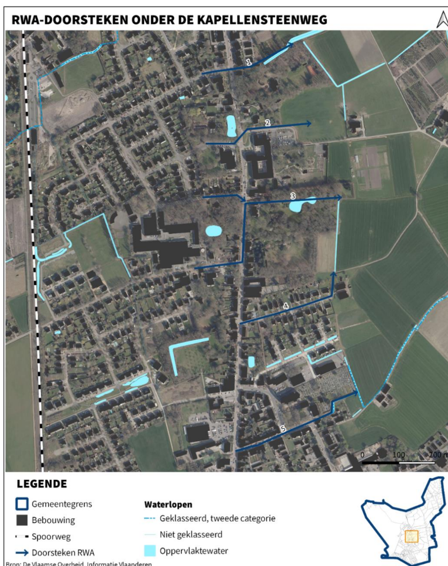
Kaart 19: Voorgestelde locaties voor het voorzien van RWA-doorsteken onder de Kapellensteenweg om het centraal binnengebied van haar hemelwater te ontsluiten.
